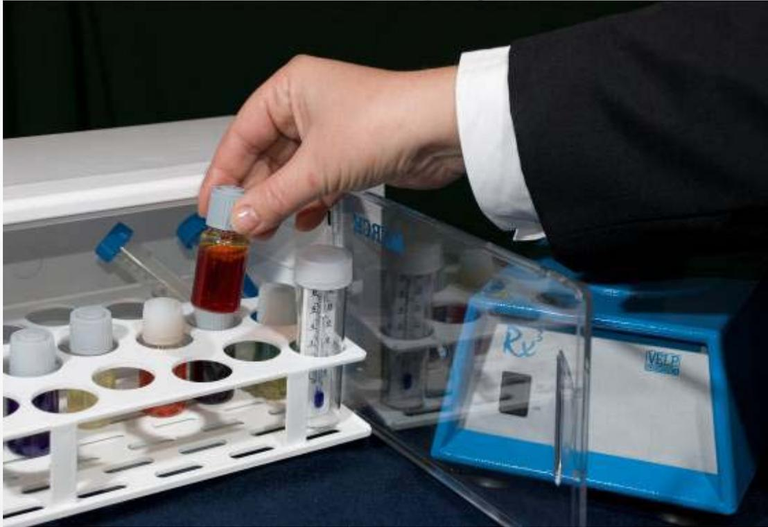
Dopo il dissolvimento del reagente, il flaconcino viene inserito in un termostato ed in circa 15 minuti si sviluppa il colore iniziale.
