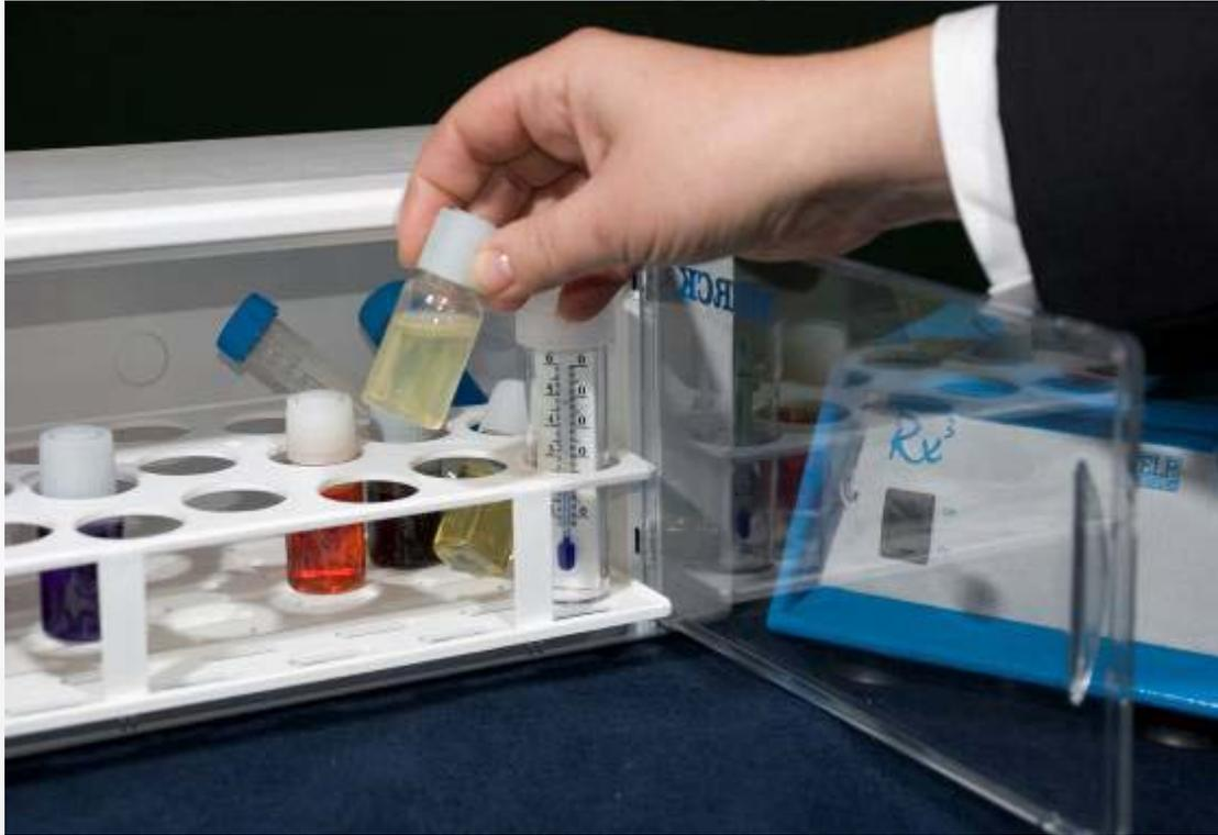
Trascorso il numero di ore prefissato in base al tipo di analisi da effettuare, il flaconcino viene tolto dal termostato e viene osservato il colore alla fine della prova.
