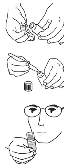
La auto esterilización post-análisis, se efectúa realizando una pequeña presión sobre el tapón y permite deshacerse de manera segura de la ampolla.
