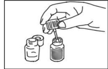
**Nota Bene:** con il tappo del flacone di analisi è possibile richiudere il flacone contenente la soluzione neutralizzante prima di smaltirlo.
