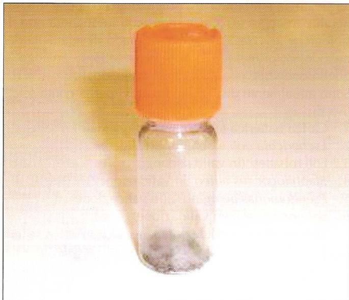
**Fig. 3** - Fiala monouso che viene fornita pronta all'uso, sterile e contenente tutti i reagenti necessari per l'analisi. La fiala ha una capacità totale di circa 13 ml e deve essere riempita con il campione da esaminare (ca. 1 g) e con 10 ml di acqua sterile che viene fornita in un fialoide presente nella confezione.
