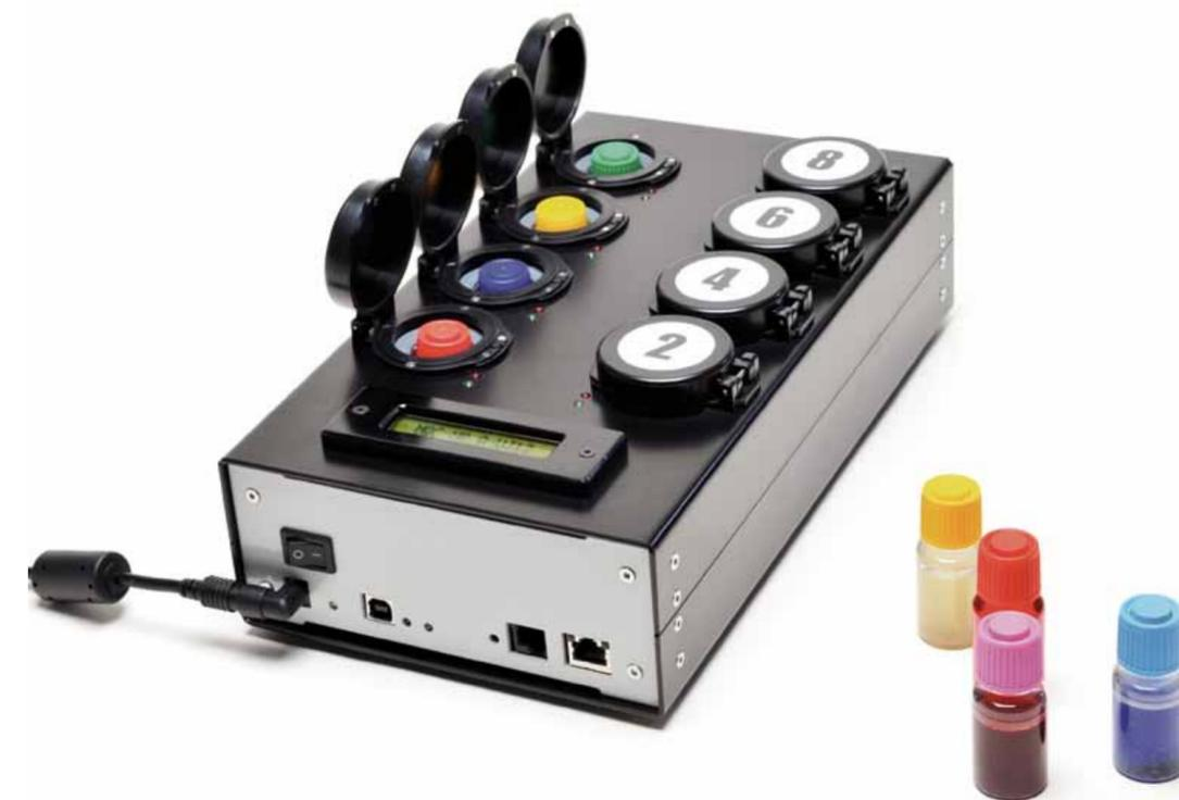
Il dispositivo **MBS-MultiReader** automatizza il processo di analisi consentendo l'esecuzione contemporanea ed indipendente di più prove, senza dover controllare il cambiamento di colore dei flaconi.
