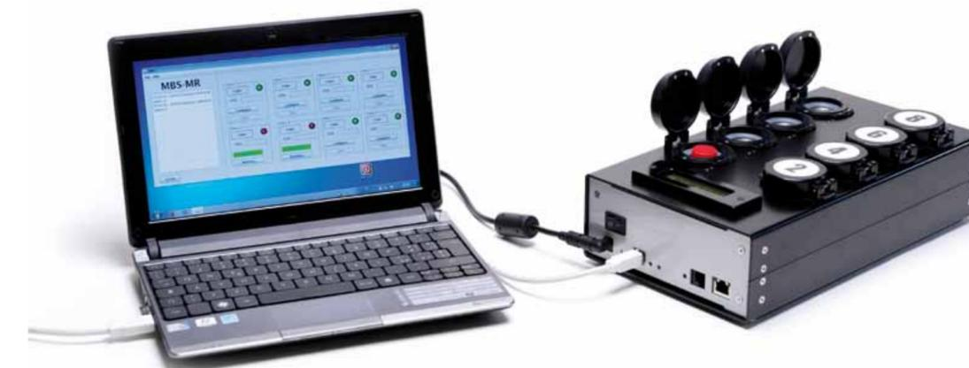
**MBS-MultiReader** fornisce automaticamente il numero dei microrganismi presenti nel campione. Il dispositivo è collegato e controllato da un computer sul quale è installato uno specifico software. Al termine della prova è possibile stampare il Report di Analisi, che viene fornito dal sistema.
